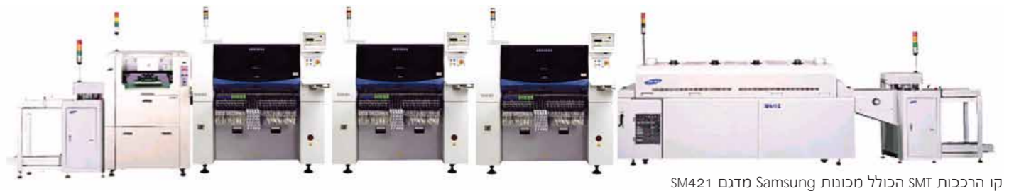
הרכבות SMT הכוללות מכונות Samsung מדגם SM421
